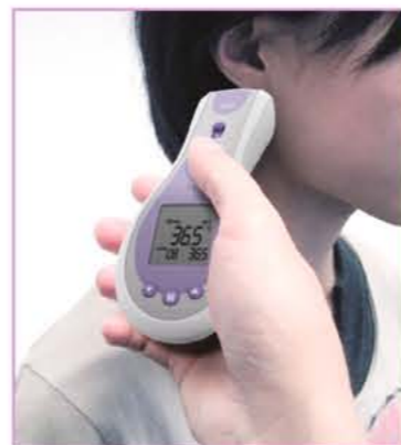
Измерение температуры тела с компенсацией температуры в помещении
